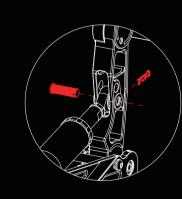
更换油门踏板的安装孔位 可对油门踏板进行软硬调节
