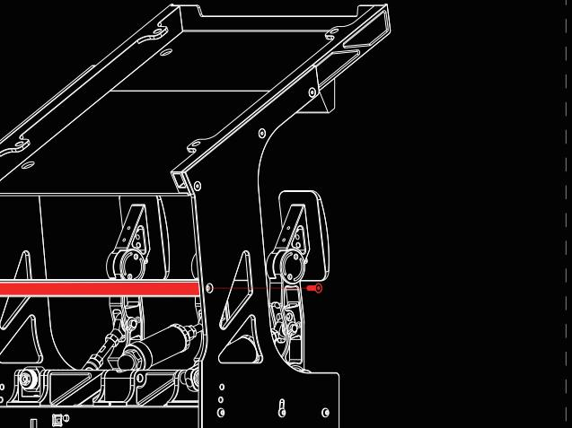
1、用内六角扳手取出支撑条两侧的固定螺钉, 取下支撑条, 将踏板以立式踏板的姿态摆放
