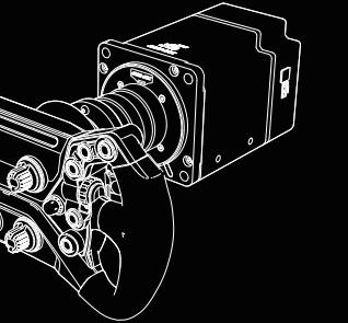
连接基座时,将方向盘插入基座
