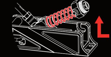
4.1 旋转尾部紧固螺丝可微调弹簧力度
