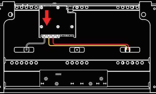
2.2 松开刹车模块连接底板的四颗螺钉
