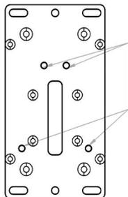
M6螺纹安装孔
