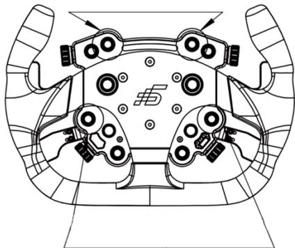
同时按住5秒进入功能检测模式。按键、旋钮、拨片正常运行时，进行任意操作会使灯光进行切换
